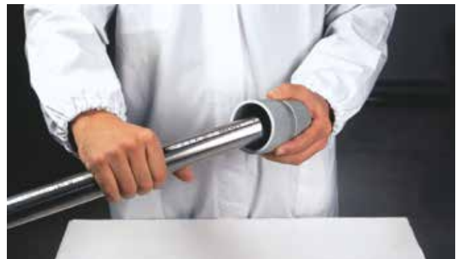
Joonis 26 – Torult kidade eemaldamine
