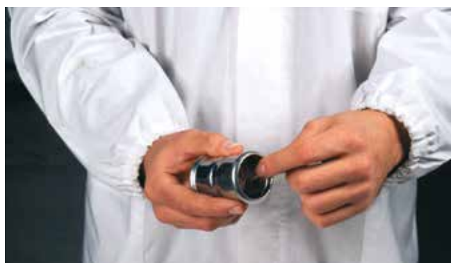
Joonis 30 – Tihendusrõnga kontrollimine
